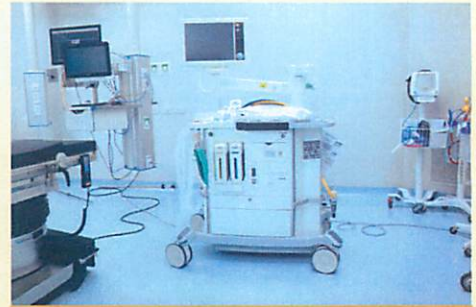
ANESTHESIA MACHINE เครื่องดมยาสลบ เป็นเครื่องที่ใช้ให้ยาสลบ และช่วยหายใจขณะทำการผ่าตัด
